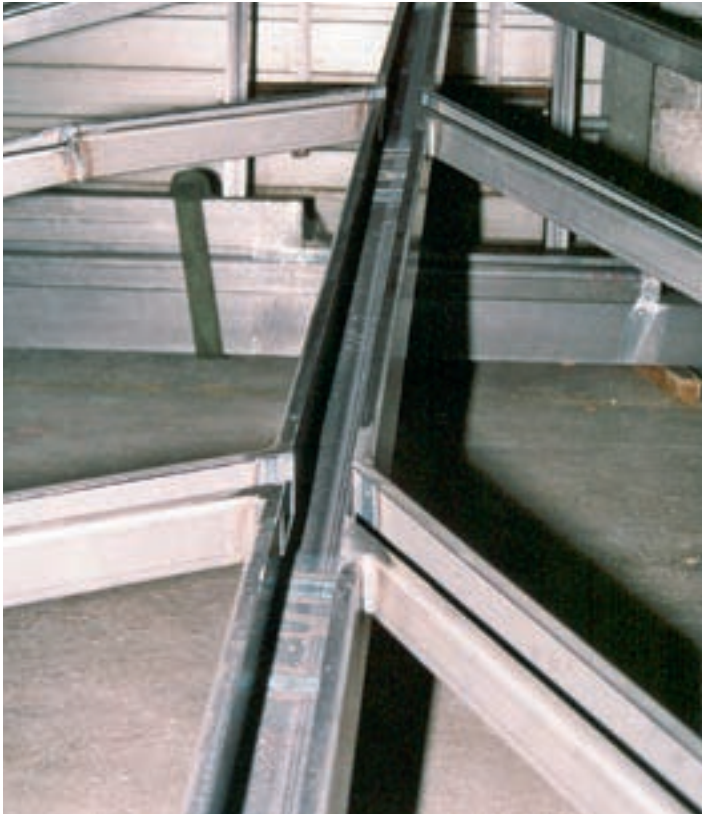
Oben: Fabrikation im Werk der Fa. Blaser AG in Andelfingen Links: Abkantprofile als Glasauflage und Entwässerung
