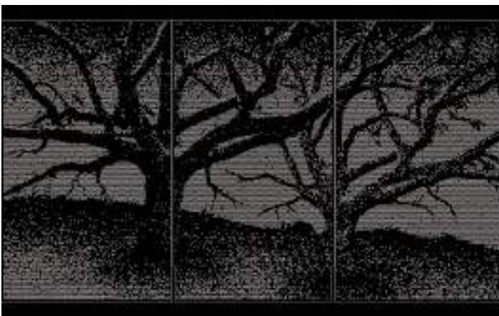
Berechnete Rasterung auf Basis des Eingabebilds und einer Auflösung des Perforationsmusters pro Paneel von 220 \times 134 Löchern mit gleicher Lochgröße \varnothing 8 \text{ mm} . Resultat: Motiv ist gut erkennbar. Die Lochung ist jedoch weniger lebendig/interessant. Trame calculée à partir de l'image paramétrée et d'une résolution du modèle de perforation de 220 \times 134 trous de taille similaire ( \varnothing 8 \text{ mm} ) pour chaque panneau. Résultat : le motif est clairement reconnaissable. Cependant, la perforation est moins dynamique, moins intéressante.
